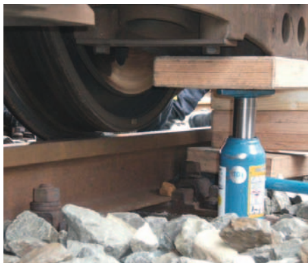
Anheben und Unterbauen mit einem LKW-Wagenheber.
