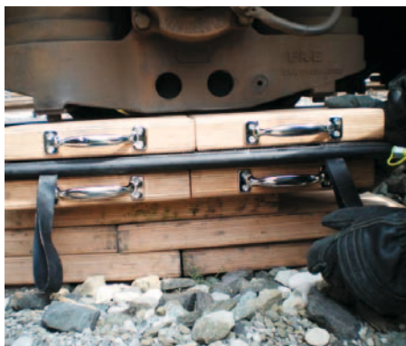
Hier ein Versuch mit Hebekissen.
