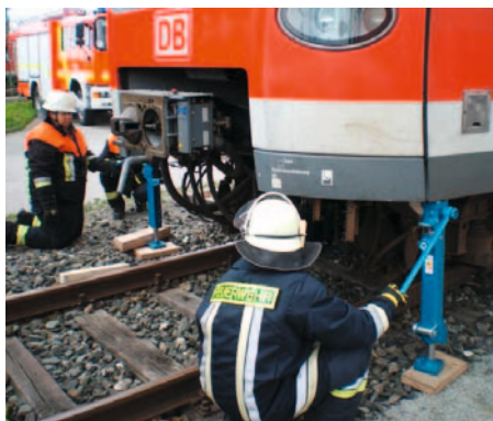
Anheben der S-Bahn im Frontbereich mittels Hydraulischer Winden.
